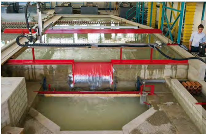
Modellbetrieb im Labor: Das Kraftwerk versteckt sich in einer Kiste vor dem Wehr. Eine Klappe im Wehr lässt Wasser und auch Fische passieren.
