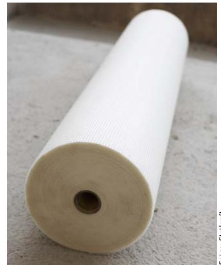
Das Herzstück des Kraftwerksprototyps: die aufgerollte Membran, eine halbdurchlässige Polymerschicht
