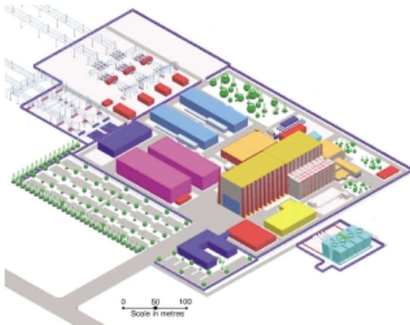
Das ITER-Gelände mit der Experimentierhalle (gelb) umgeben von Versorgungseinrichtungen.
