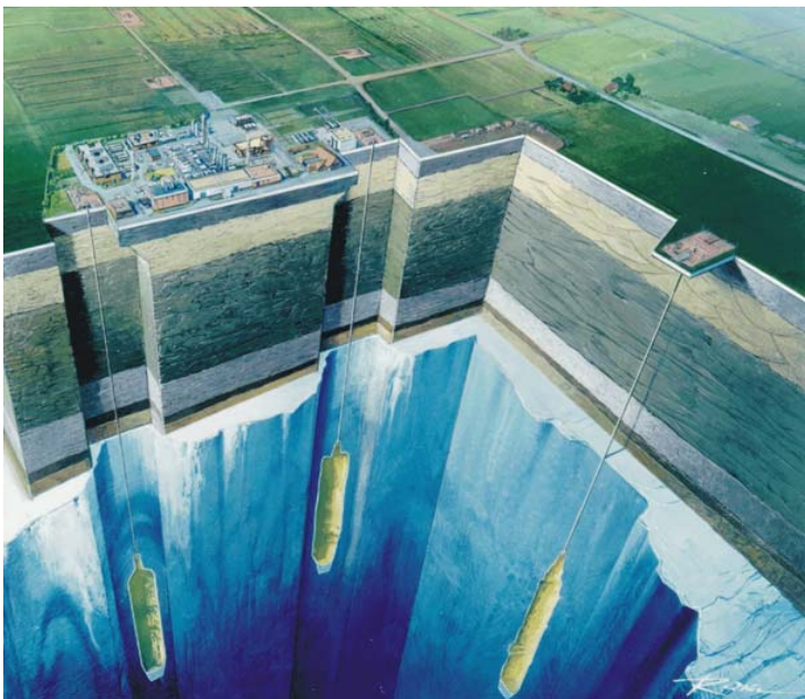
Abbildung 1: Salzkavernen zur HD-Erdgasspeicherung
